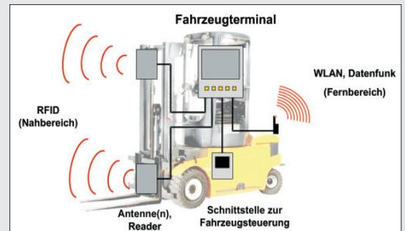
Die einzelnen Ereignisse wurden in Form von XML-basierten Botschaften definiert. Tritt ein solches Ereignis auf, sendet die Ereignis-Box die zugehörige XML-Botschaft an das Staplerterminal. Dort kann dann mit Hilfe von auf dem Terminal hinterlegten Algorithmen der Reader angesteuert bzw. überprüft werden, ob die vom Reader empfangenen Daten sinnvoll sind. Erst nach dieser Plausibilisierung werden die Daten an die übergeordneten DV-Systeme weitergeleitet.
