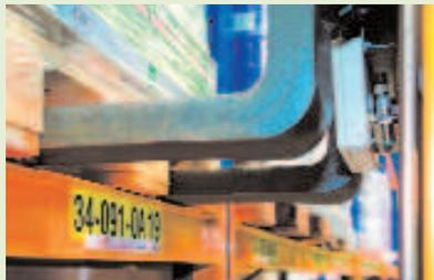
RFID-Technologie am Gabelstapler zur Erkennung des Lagerplatzes
